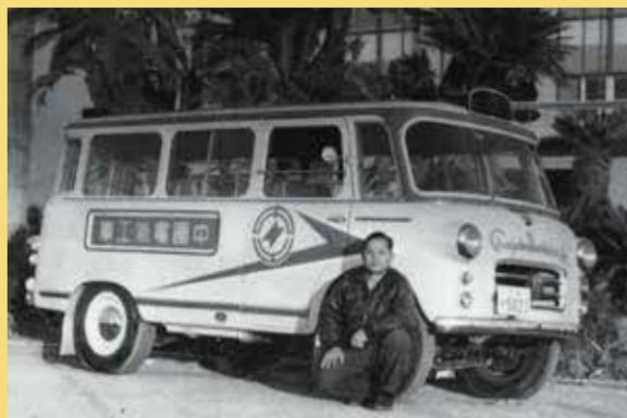
中国電気工事(中電工)の特装車。フロントには英文で社名が入っている。ベース車はトヨペットルートトラック。
